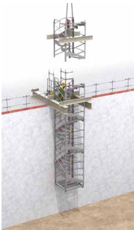
>Principe de réhausse d'un Escalib mills pour fond de fouille
