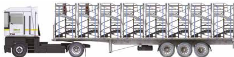
Exemple de chargement d'Escalib Mills. - Plateau courant (12 m) : 7 modules et 7 embases. - Plateau rallongé (13,50 m) : 8 modules et 8 embases.
