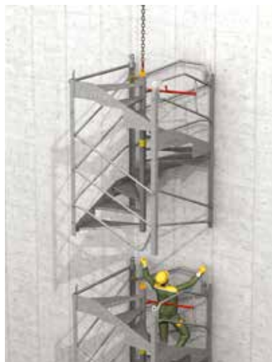
Pose ou dépose d'un module
