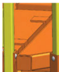
Cornière d'appui sur la passerelle de la banche
