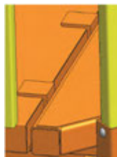
Cornière d'appui sur la passerelle de la banche
