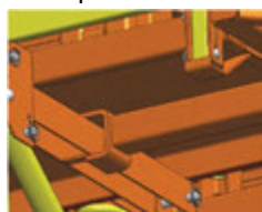
Vis H14/130 + Plaque avec écrou soudé
