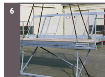
6 PCE avec grand pied verrouillé prêt à l'emploi. Mise en place de l'échelle et réglage des pieds après positionnement dans la cage d'escalier
