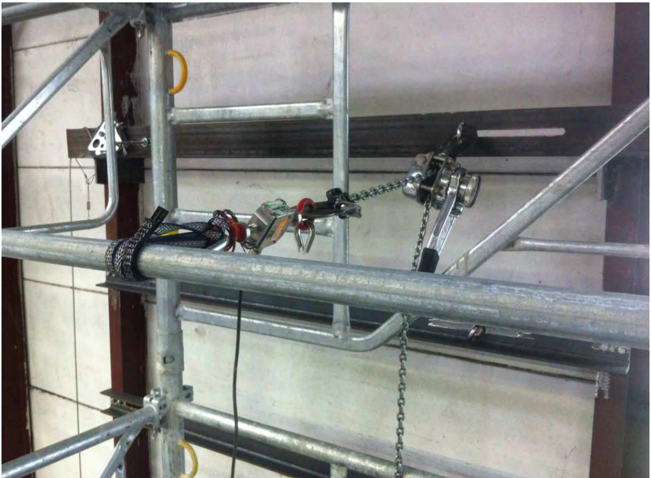
Etat limite ultime sur la lisse supérieure
